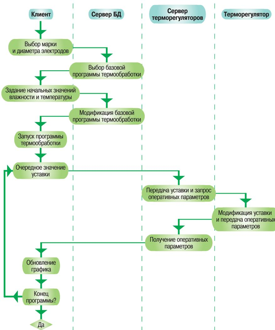
Рис. 4. Схема программы термообработки электродов
