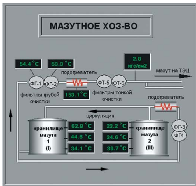
Рис. 1. Мнемосхема мазутного хозяйства
